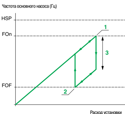
Работа основного и вспомогательного насосов: гистерезис
